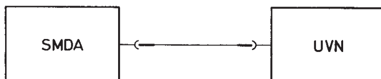
Bild 3-8 Messen der Ausgangsspannung des Modulationsgenerators
