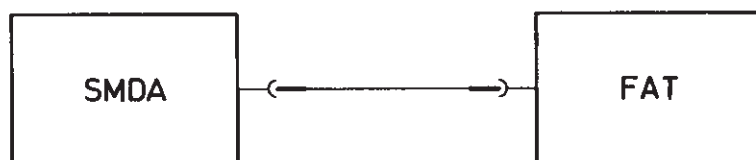
Bild 3-9 Messen des NF-Klirrfaktors des Modulationsgenerators
